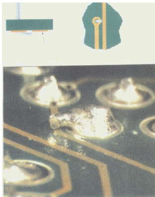
图 12 引脚与走线搭接（为不合格焊接）
